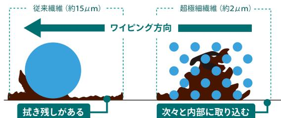
従来繊維では、油膜や粉塵を引き伸ばすだけで、完全に拭き取ることができません。超極細繊維は拭き取り面に密着し、毛細管現象により繊維空隙に汚れを次々と取り込むことができるので(インナートラップ機能)高いワイピング性能を発揮するのです。
