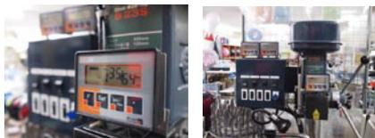
ピッチ側の2軸とドリルの深さを確認するスケールの3センサーを追加できます。これにより、正確にピッチや深さを確認することが可能に!
